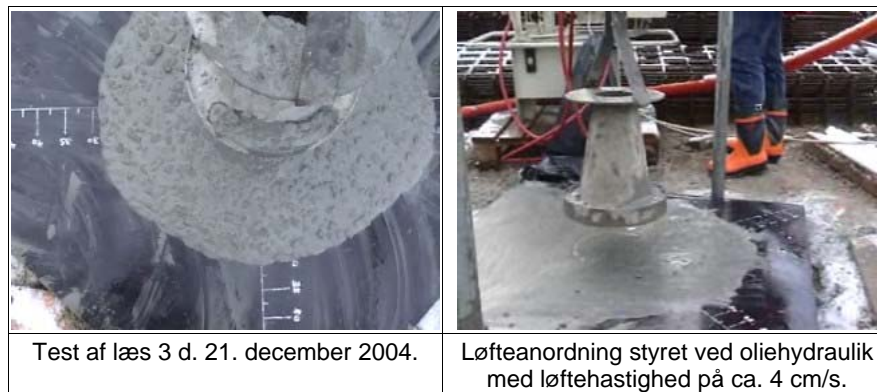
Figur 3-6: Eksempel på test med en prototype af 4C Auto Slump Flow systemet.
