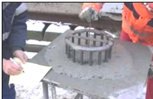
Figur 5-1: Eksempel på J-Ring test på byggepladsen.
