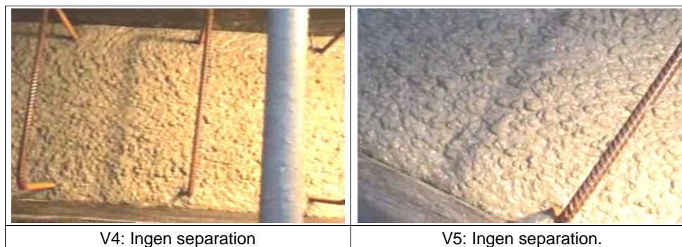
Figur 5-4: Billeder fra toppen af væg V4 og V5. Stenene ses tydeligt i overfladen.
