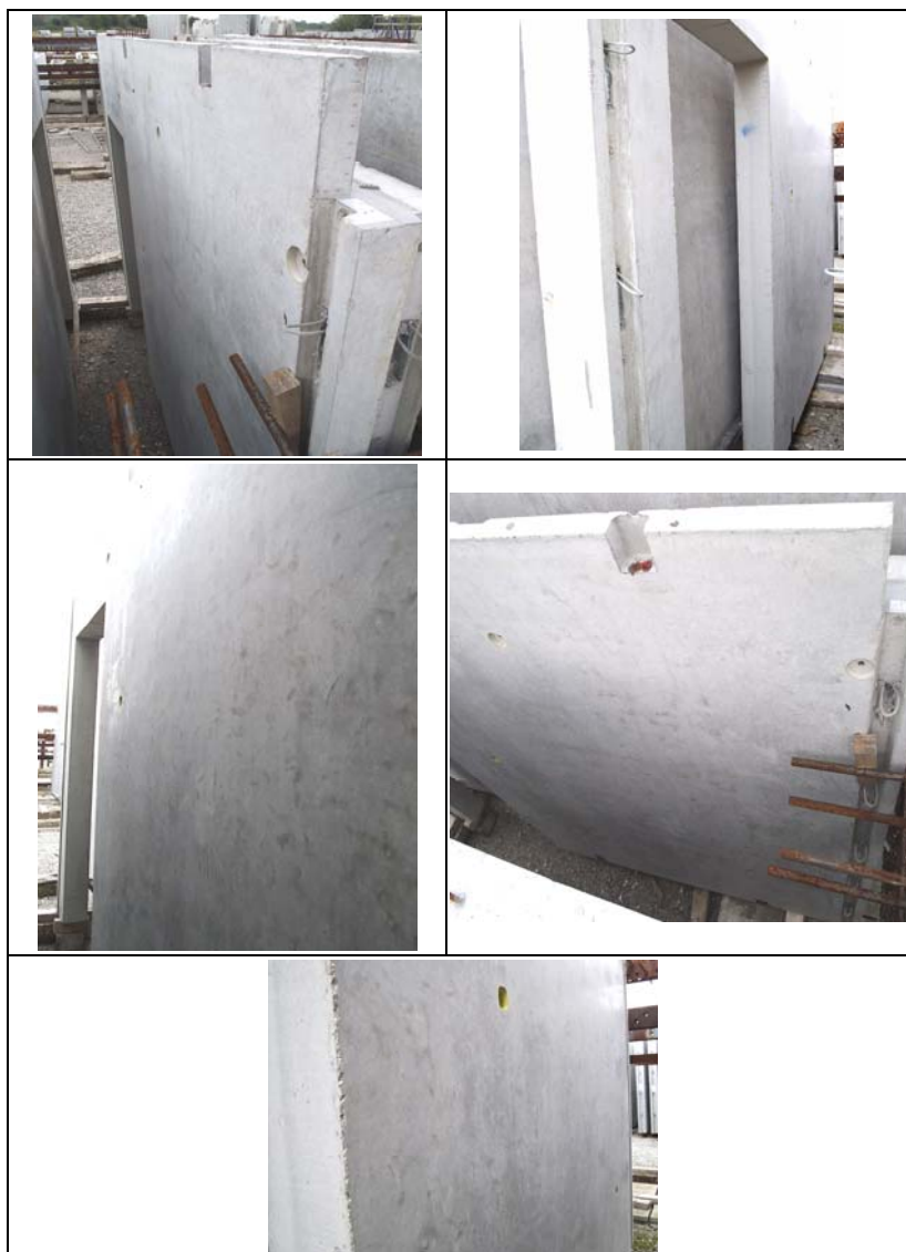
Figur 3-3: Billeder af test element udført med SCC beton med ekstra fint sand (BE Fintsand2).
