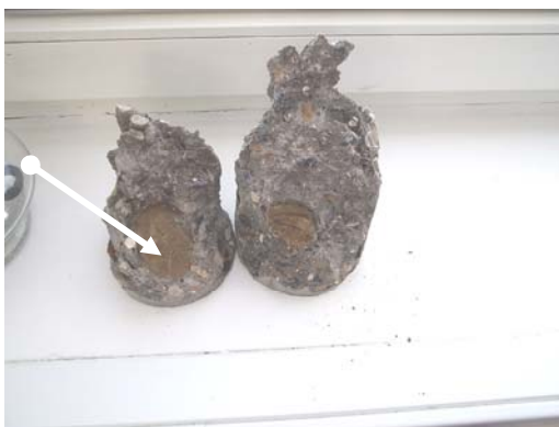
Figur 3-2: Billede af prøveemne med fint sand (BE Fintsand2) efter trykstyrkeprøvning ved 28 døgn. I de store huller har det fine sand kittet sig sammen, hvilket indikerer at det ikke er blevet dispergeret under blanding.
